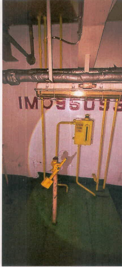
الصورة 29: خزان مانع التسرب لأنبوب المؤخرة
